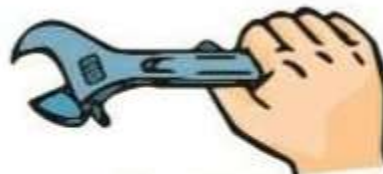
Manera 2. Tomando la llave inglesa de la punta.
